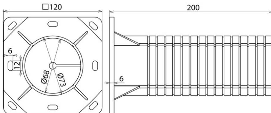
Ausführung mit Styroporkern (keine Wärmebrücke) zum Kombinieren mit dem Trennstellenkasten. Der Abstandshalter kann in 10 mm Abstufungen von 200 - 50 mm gekürzt werden.
