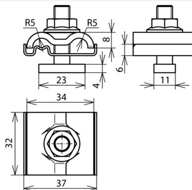
Erdungsklemmen zum Einbinden der Montagesysteme z. B. von PV-Anlagen in den Funktionspotentialausgleich/Funktionserdung (Leiterfarbe ggf. schwarz) und Blitzschutz-Potentialausgleich nach DIN EN 62305-3 (VDE 0185-305-3)
