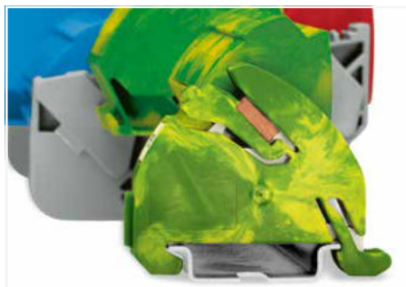
PE-Sammelschienenträger (812-141) Er bietet eine Rastaufnahme für Sammelschienen (10 x 3) mm. Die Montage auf die Tragschiene 35 erfolgt komfortabel durch einfaches Aufrasten. Dabei wird automatisch der Kontakt zwischen der Sammelschiene und der Tragschiene hergestellt. Die Sammelschienenposition entspricht der mittleren Position des isolierten Sammelschienenträgers.
