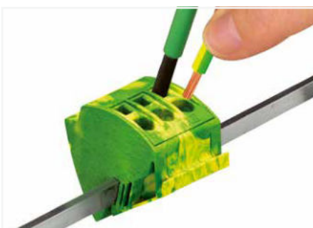
Leiteranschluss 16 mm 2 Klemmstelle für ein-, mehr- und feindrähtige Leiter mit Betätigungswerkzeug öffnen.
