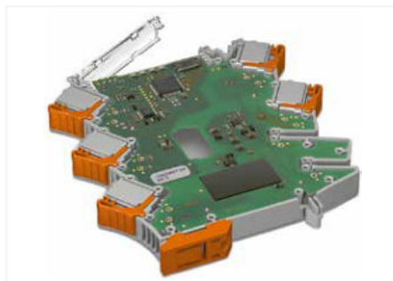
2. Leiterplatte einlegen und verlöten.
