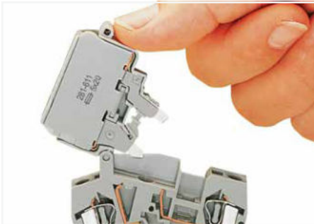
Vor dem Auswechseln der Sicherung Sicherungshalter in Endposition ausschwenken (Raststellung)
