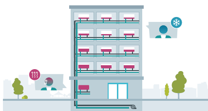
Statischer hydraulischer Abgleich: ungleichmäßige Energieverteilung unter Teillastbedingungen.
