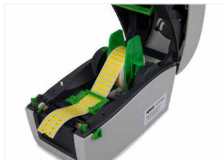
Zweiten Flügel auf dem Steg fixieren, den Steg wieder im Gehäuse fixieren und Führungsschienen locker an das Material anlegen.
