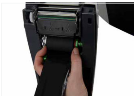
Vollen Kern des Farbbands unten einlegen.
