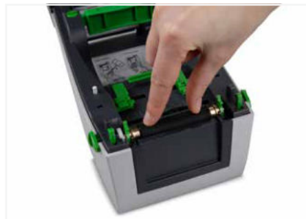
Passende Walze im Drucker fixieren.
