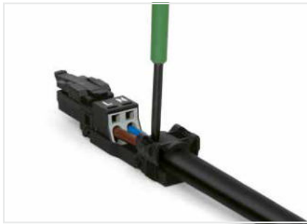
Zugentlastungsschelle mit Schraubendreher (Klingenbreite 2,5 mm) auf beiden Seiten wechselseitig herunterschieben.
