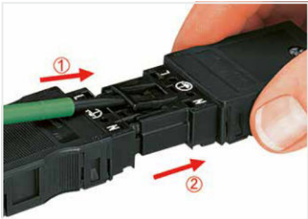
Verriegelungsklinke für Werkzeugbetätigung: • Verriegelungsklinke aufhebeln. • Steckverbindung auseinanderziehen.
