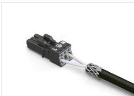
Schirm um Mantelleitung legen. Abmantelllänge = 40 mm Schirmlänge = 8 mm
