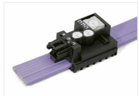
Nach der Kontaktierung zur Flachleitung ist die Schalteinheit arretiert und kann auch nach Zurückdrehen des Drehelementes nicht mehr verschoben werden!
