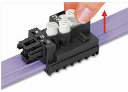
Durch Hochziehen des Drehelementes kann die Arretie- rung gelöst und durch Schieben der Schalteinheit die neue Phase gewählt werden. Achtung: Nicht an gleicher Stelle der Flachleitung verwen- den!
