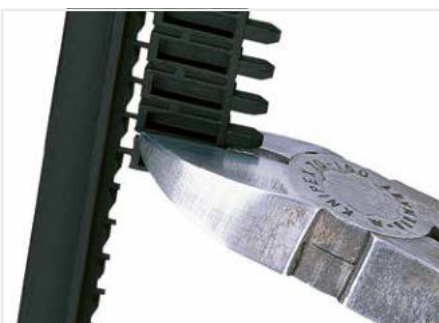
Nicht benötigte Bereiche aus den Seitenwänden heraus-trennen.
