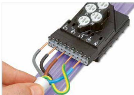
Anschließen einer Mantelleitung an das Einspeisemodul Abisolierte eindrähtige Leiter sind direkt steckbar. Für abisolierte feindrähtige Leiter Klemmstelle vorher mit Schraubendreher öffnen.
