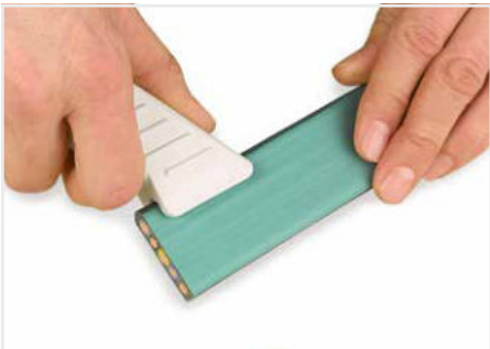
Flachleitungsmantel mit Abisoliermesser an beiden Seiten aufschneiden.
