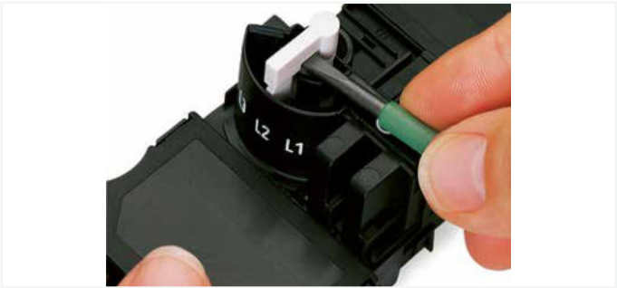
Den Schaltbrücker aus der Lieferposition (L2) mittels Schraubendreher heraushebeln und in die gewünschte Position drehen.
