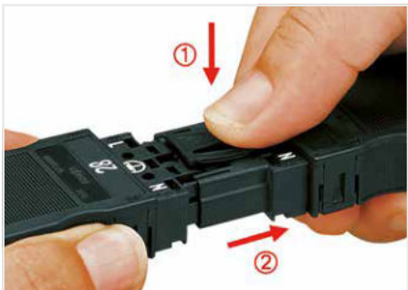
Verriegelungsklinke für Handbetätigung: • Auf Verriegelungsklinke drücken. • Steckverbindung auseinanderziehen.
