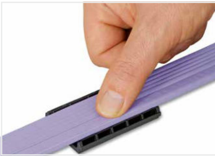
Flachleitung in das Unterteil einlegen (Kodierung beachten!).
