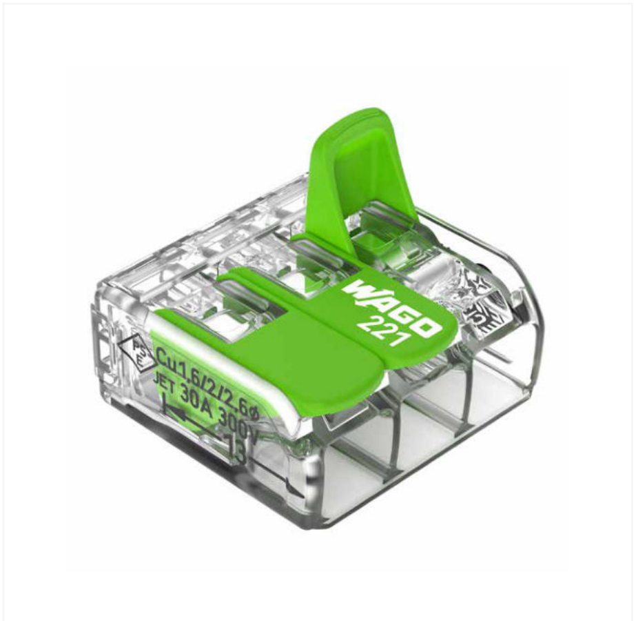
4 mm 2 : Sie klemmen bis zu 10 abisolierte, feindrähtige Leiter 0,14 ... 4 mm 2 , ein- oder mehrdrähtig 0,2 ... 4 mm 2 6 mm 2 : Sie klemmen bis zu 5 abisolierte, eindrähtige, feindrähtige oder mehrdrähtige Leiter 0,5 ... 6 mm 2 – und das ohne Werkzeug!
