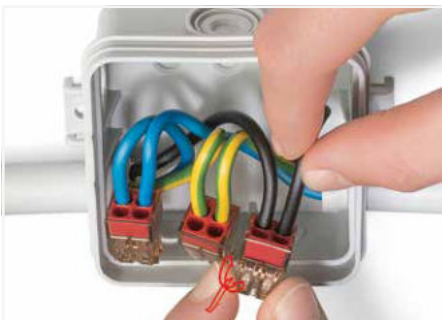
Lösen: Leiter festhalten, Klemme durch Hin- und Herdrehen mit leichtem Zug vom Leiter ziehen.
