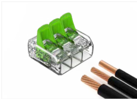
4 mm 2 : Sie klemmen bis zu 10 abisolierte, feindrähtige Leiter 0,14 ... 4 mm 2 , ein- oder mehrdrähtig 0,2 ... 4 mm 2 6 mm 2 : Sie klemmen bis zu 5 abisolierte, eindrähtige, feindrähtige oder mehrdrähtige Leiter 0,5 ... 6 mm 2 – und das ohne Werkzeug!
