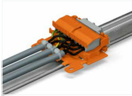
Liegende Montage mit Zugentlastungsplatte auf Tragschiene 35 mittels Universal-Winkeladapter
