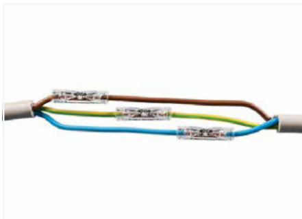
Leiter gemäß Vorgabe 10 mm abisolieren und Verbinder setzen. Beispielhafte Darstellung mit versetzten Verbindern.
