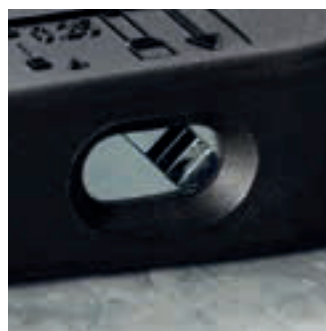
Vierkant-Crimpstelle für Aderendhülsen 0,25 – 4 mm 2
