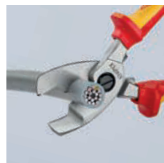
Nachschnitt: Nachdem der Mantel des Kabels im vorderen Profil durchgeschnitten wurde, werden die Leiter im hinteren Profil durchtrennt. Vorschritt vorn, Nachschnitt hinten – so schneidet es sich leichter.
