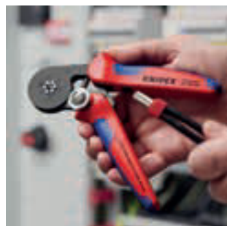
Sechskant-Crimp mit automatischer Größenanpassung
