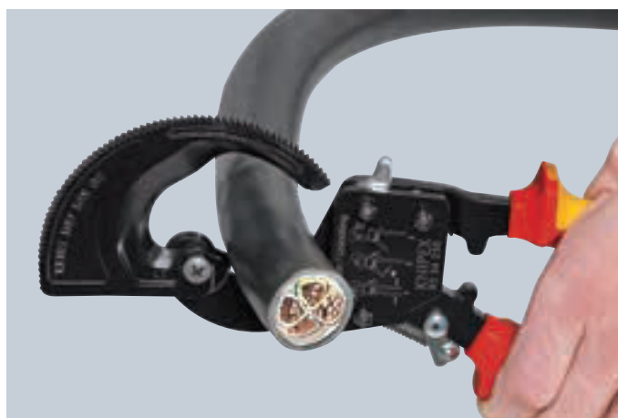
Ratschenprinzip und Zweigang-Zahnkranz-antrieb für kraftsparendes Schneiden
