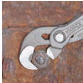
Arbeiten an verrosteter Mutter mit verrundeten Kanten
