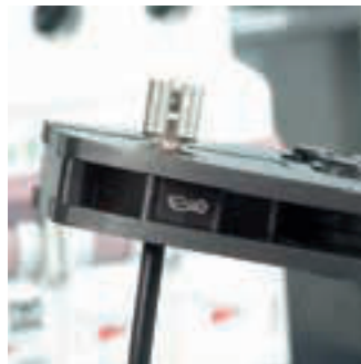
Gut sichtbare Kennzeichnung der Crimpeinsätze mit Piktogrammen
