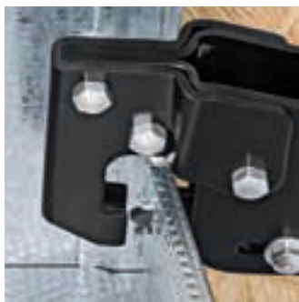
Das Stempelwerkzeug wird durch die Profilbleche gedrückt
