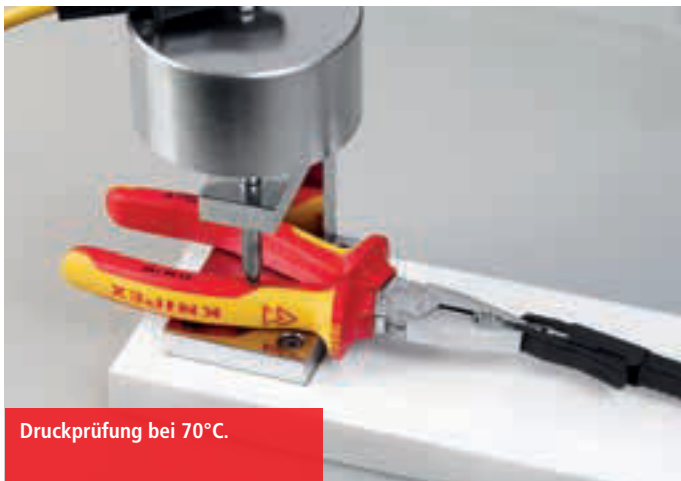
Prüfung der Haftfähigkeit der VDE-Hüllen mit 500 N.
