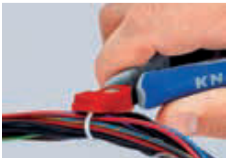
Mit dem Elektronik-Seitenschneider den Kopf des Kabelbinders abschneiden...
