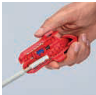
Abmanteln eines NYM-Kabels
