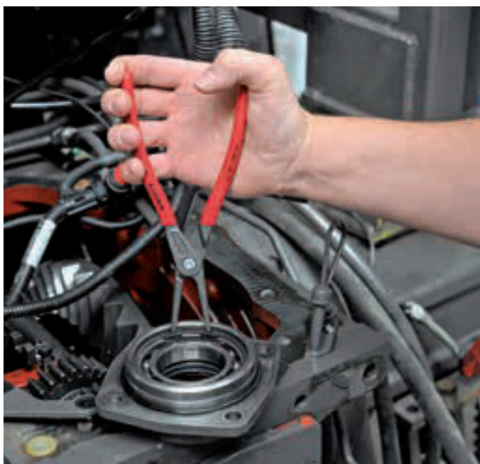
Stabile, eingesetzte Spitzen aus hochverdichtetem Federstahl
