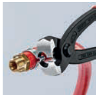
Abdichten Fluidschlauch an Stutzen mittels Seiten-Pressnase
