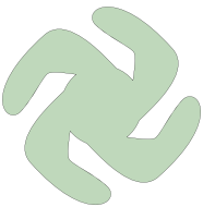
Spezifische Kontaktstücke in Vakuumschaltröhre
